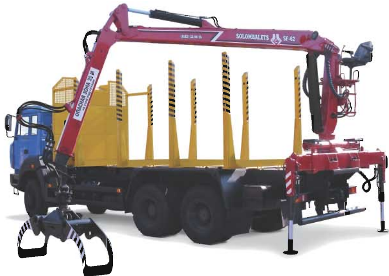
Автомобиль - лесовоз на базе а/м Урал 63685 с гидроманипулятором СФ-62
