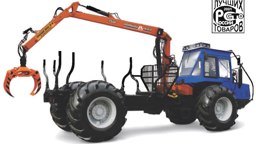
Машина лесная погрузочно-транспортная Беларусь МЛ-354 с манипулятором СФ-65Л
